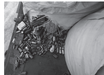
↑フレコンバッグが破損し、電池が漏洩している様子
